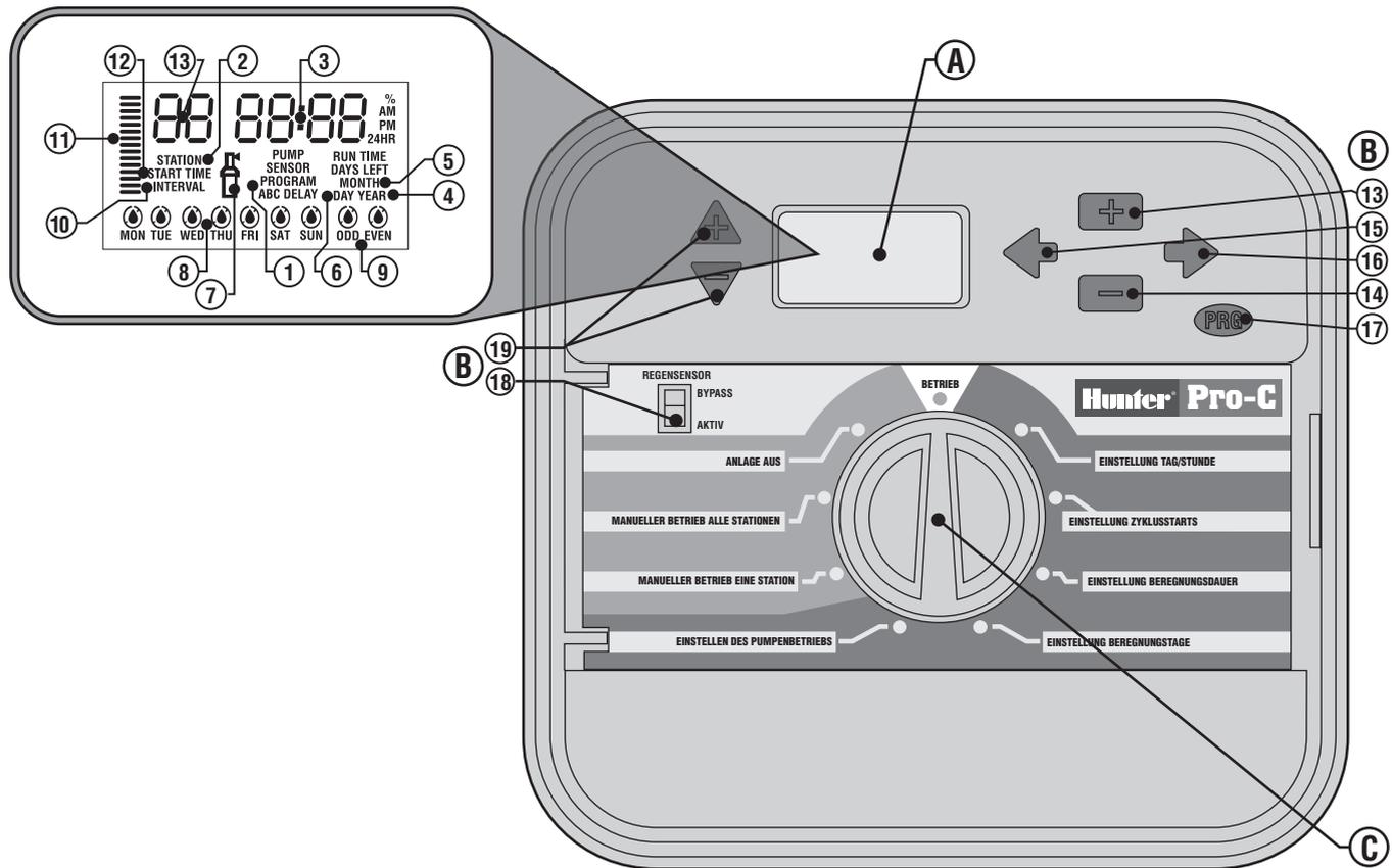
Dieser Abschnitt gibt Ihnen eine Kurzübersicht über einige der Pro-C Komponenten. Jeder einzelne Bestandteil wird später im Detail näher behandelt. Jedoch hilft Ihnen dieser Abschnitt, sich vorab mit dem Steuergerät vertraut zu machen.
