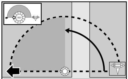
Die Beregnungsfläche liegt zwischen dem Pfeil auf der Kappe und dem rechten Stopp-Pfeil auf dem Bogeneinstellring. In diesem Beispiel ist sie auf 180° eingestellt.
