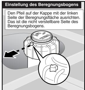
Die Beregnungsfläche kann zwischen 30° und 360° eingestellt werden. Bei der Einstellung auf 360° kehrt die Düse die Drehrichtung nicht um.
