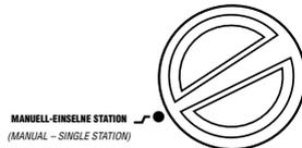
3. Drehen Sie die Wählscheibe zum Betrieb der Station auf die Position **BETRIEB** (nur die von Ihnen bestimmte Station wird die Bewässerung vornehmen; anschliessend wird das Steuergerät ohne Veränderung der zu einem früheren Zeitpunkt eingestellten Programmparameter in den Automatikmodus zurückkehren).
